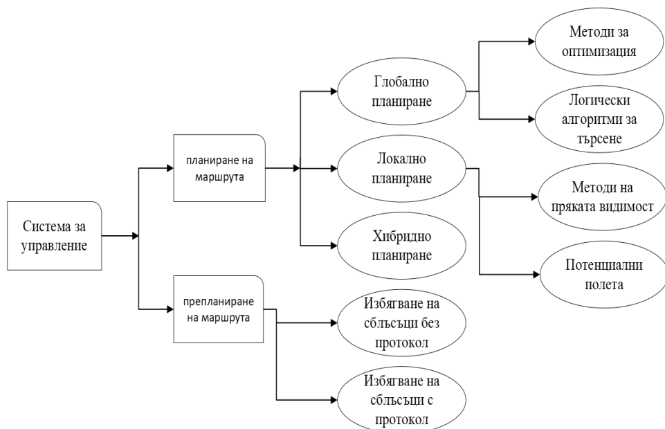
Фигура 3. Класификация на USV според системата за управление
