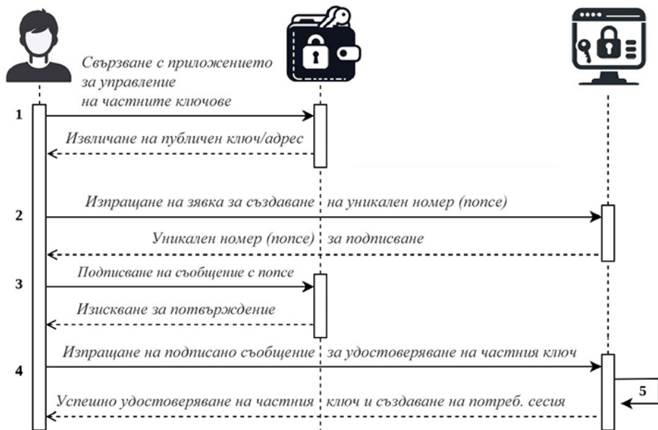
Фигура 1. Процес на удостоверяване чрез частен ключ
