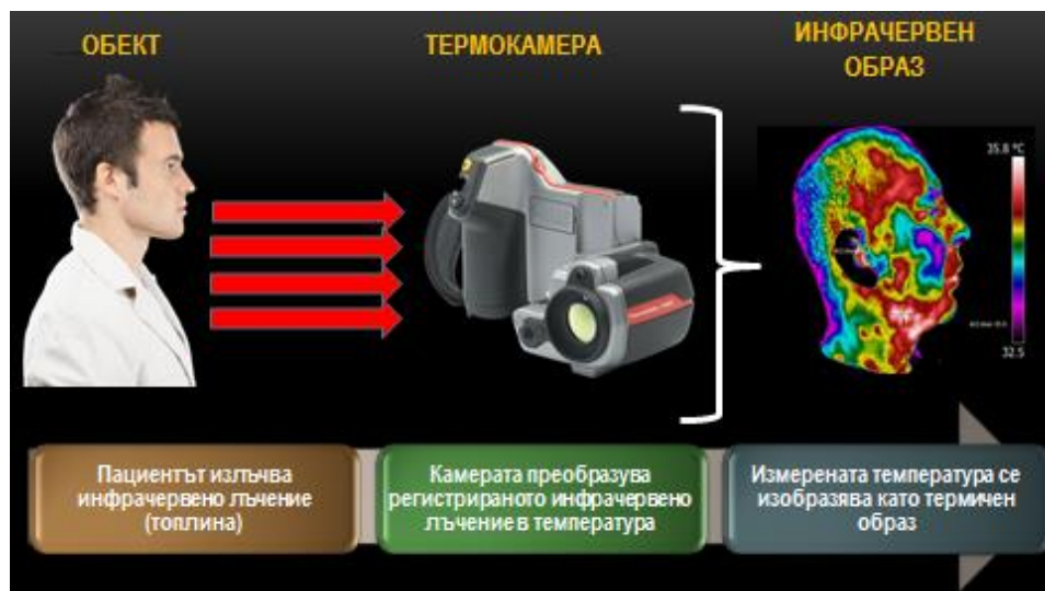
Фигура 2. Принцип на работа на инфрачервената камера
