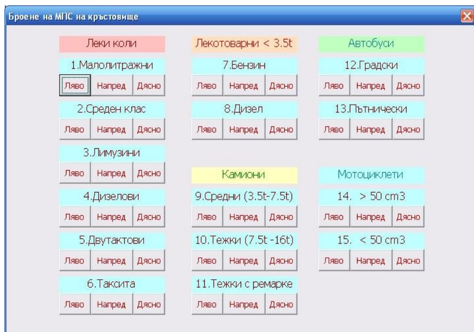
Фигура 3. Общ изглед на формата, появяваща се на екрана на компютъра при работа със софтуера за броене на преминаващи през кръстовището МПС
